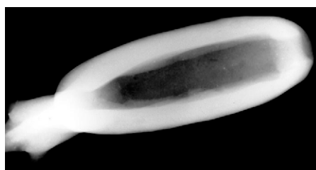
Figura 5. Imagen radiográfica con vista cenital del objeto 1441. Detalles de la toma: 50 Kv, 20 mA-75cm-foco 5,5
